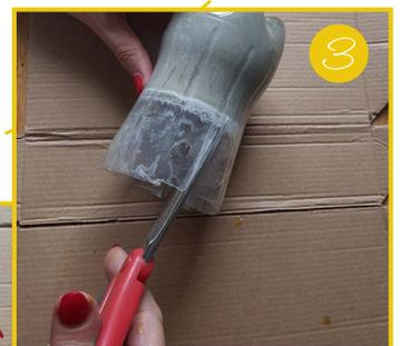
3. Erst nach **3 bis 4 Tagen** ist der Beton durchgetrocknet und lässt sich aus der Flasche schälen.
