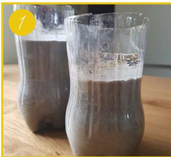
1. Sie können z. B. den restlichen Beton aus der obigen Anleitung in PET-Flaschen füllen: Einfach etwa in der Mitte aufschneiden, säubern und Beton eingießen. Gut klopfen, damit die eingeschlossene Luft entweicht!
